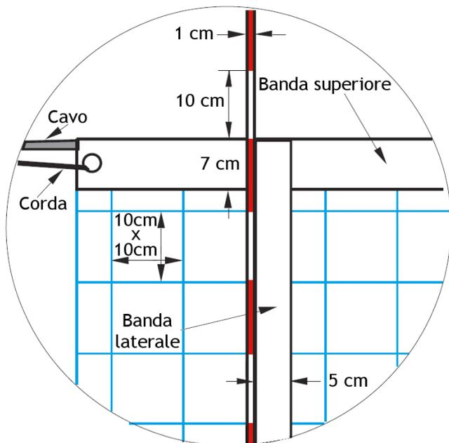
Figura 3b - Disegno della rete: particolare - R. 2.2, 2.3, 2.4
