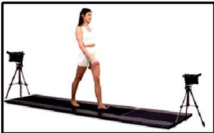
**FIG. 5 - Baropodometro Elettronico Modulare** per lo studio delle pressioni
